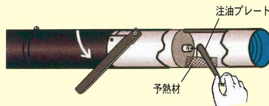
燃料開閉レバーを開き注油プレートを使って予熱材に灯油をしみこませ、燃料開閉レバーを閉じます。
