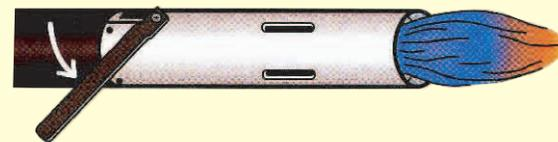
約3分で炎が大きくなります。燃料開閉レバーを開き、生火の出ないことを確認後ゆっくりと加圧して使用します。
