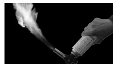
生ガスに点火すると赤い炎が大きく燃え上がり危険です。
