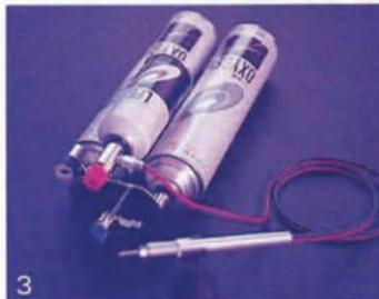
4. 先ずLPGハンドル(赤)を少し開け(OPENの方向へ)、ライターで点火します。(この時、炎があまり大き過ぎると、酸素を混合させた時に炎が消えてしまいます)
