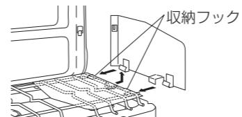
風防の上・下両フックをそれぞれフタ、本体のさし込み穴にさし込みフタと風防を固定します。
