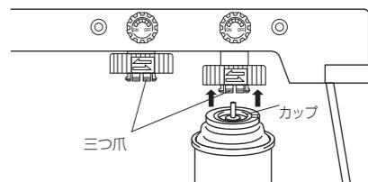
●ボンベホルダーを左方向へ止まるまでしっかりと回してボンベを固定します。
