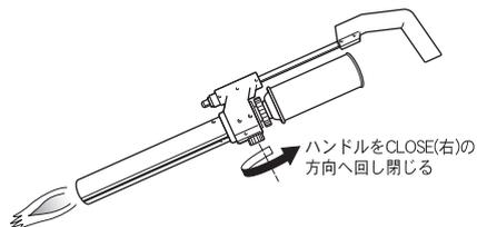
2.完全に消火した後、ポンベを取り外し作業を完了します。
